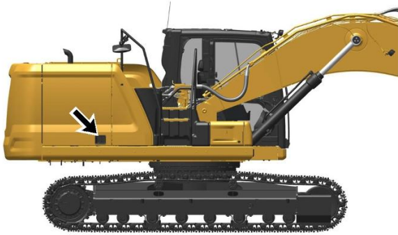
Рисунок 1 g06182545 Фильтр топливopодкачивающего насоса расположен за дверцей доступа на правой стороне машины.
