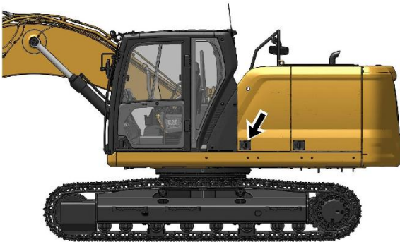
Рисунок 5 g06181546 Обеспечивает доступ к воздушному фильтру двигателя, аккумуляторным батареям и к баку стеклоомывателя.
